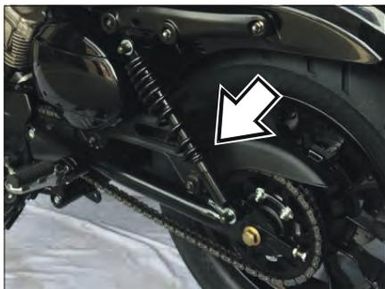
Pour ajuster la précharge du ressort, tourner le dispositif de réglage dans le sens des aiguilles d'une montre jusqu'à la position désirée à l'aide de la clé à ergots. La position 1 fournit la précharge du ressort la plus douce et la position 5 la plus rigide.
