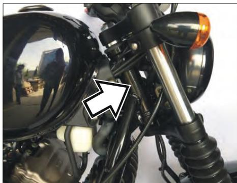
Le numéro de série du cadre est gravé sur le côté droit du tube de la colonne de direction.
