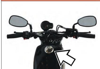
Pour ouvrir le bouchon du réservoir de carburant, insérez la clé de contact dans le verrou du bouchon et tournez-la dans le sens des aiguilles d'une montre. Une fois la clé insérée, retirez le bouchon du réservoir de carburant.
