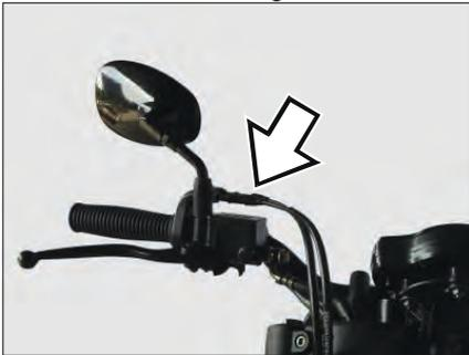
Toujours vérifier l'état de l'assemblage du capuchon en caoutchouc du câble qui doit être assemblé dans la bonne position. Vérifier l'emplacement du capuchon en caoutchouc du câble après avoir réglé le jeu du câble d'accélérateur.
