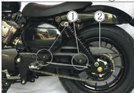
3. Placer un lève moto sous le bras oscillant pour soulever légèrement la roue arrière du sol.
